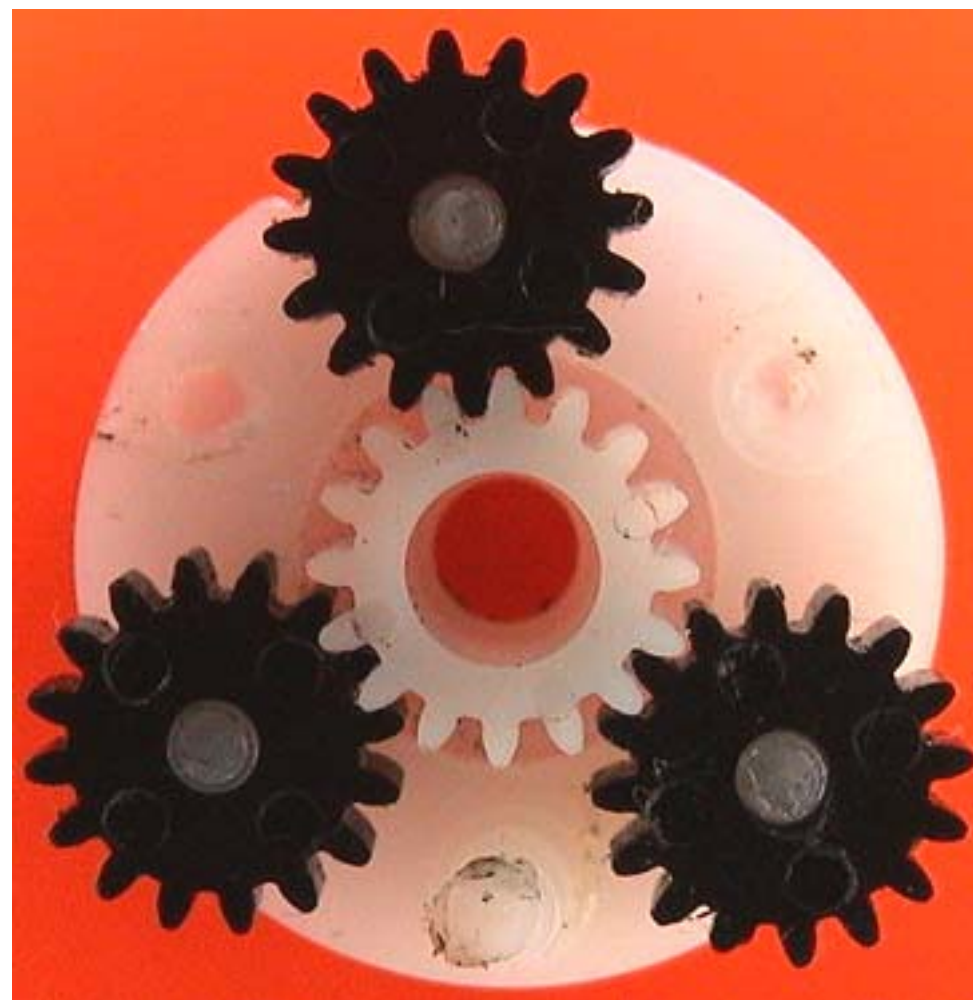
Planetová převodovka akumulátorového šroubováku
