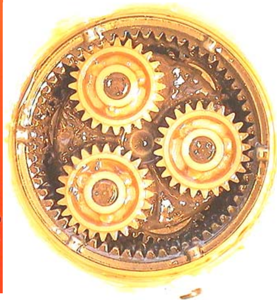
Planetová převodovka akumulátorového šroubováku
