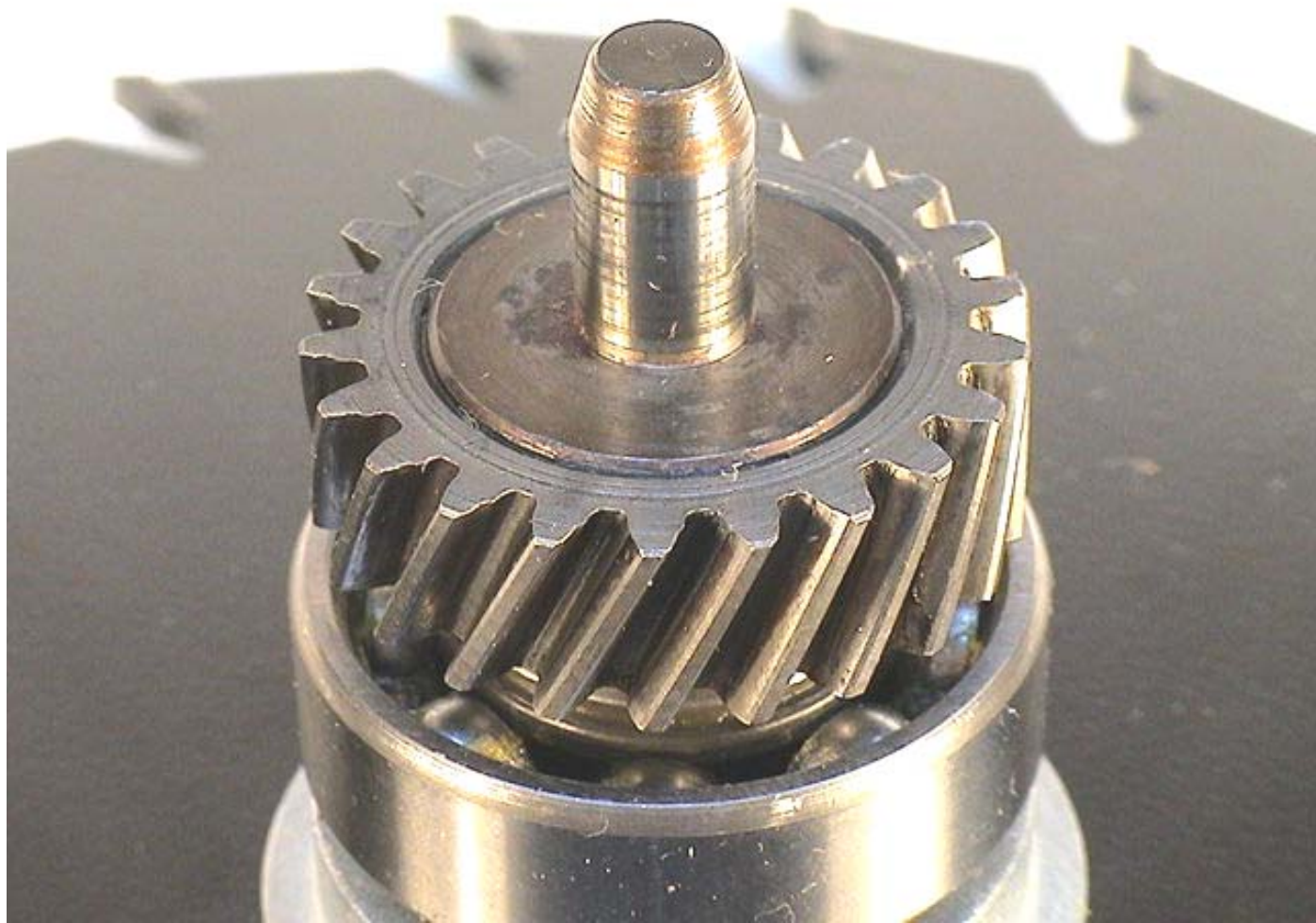
Detail ozubeného kola z ruční kotoučové pily
