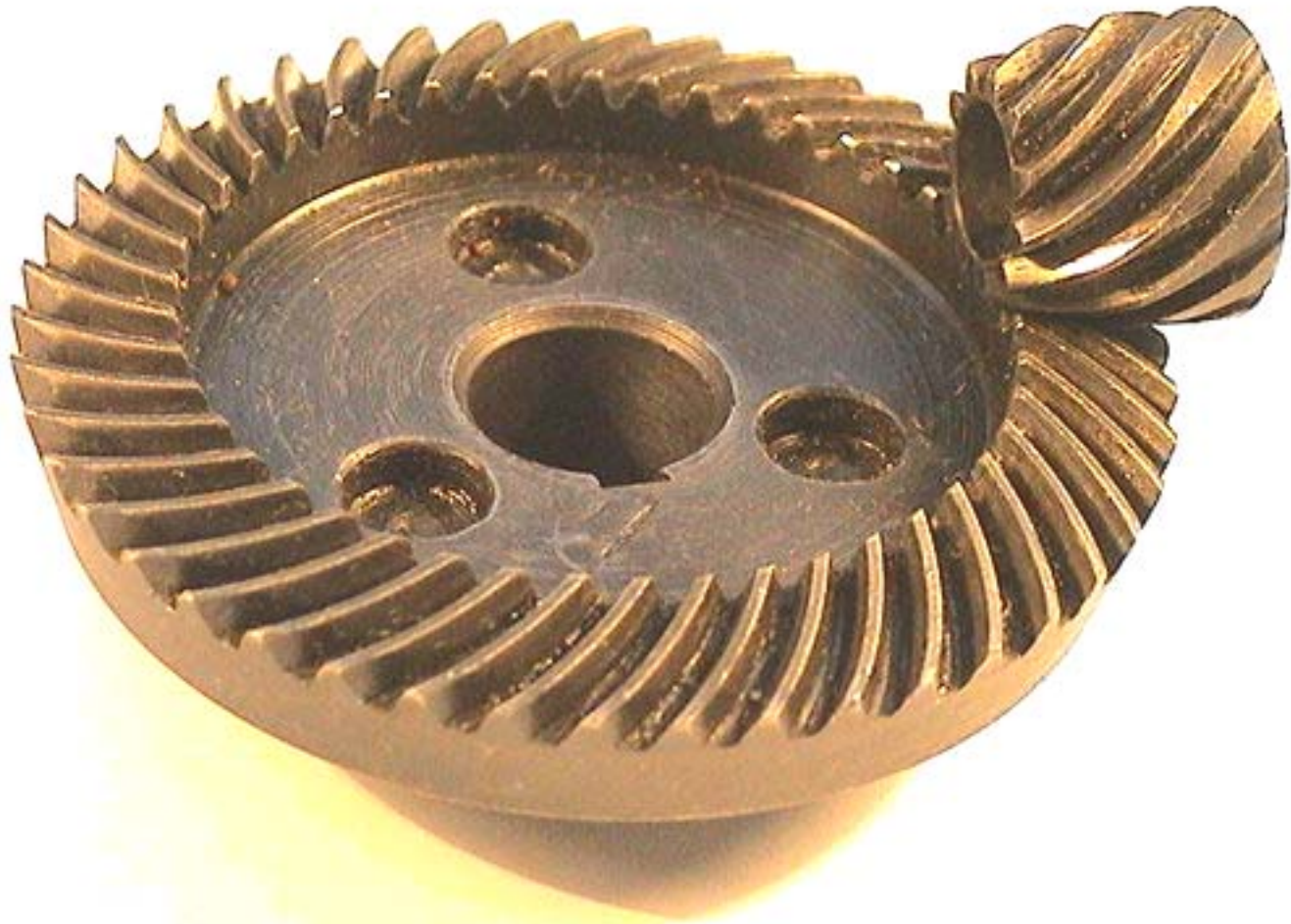
Detail převodu kuželovými ozubenými koly se šikmými zuby z úhlové brusky
