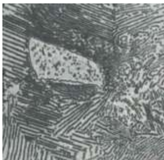
Obr. 62 Výbrus šedé litiny – lupínkový grafit
