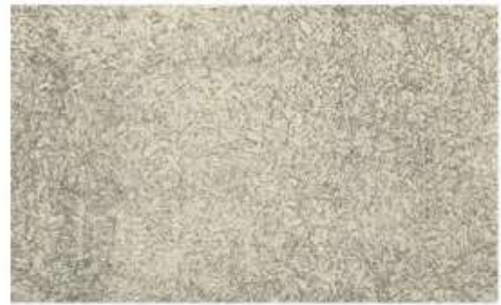
struktura martenzitu po popouštění
