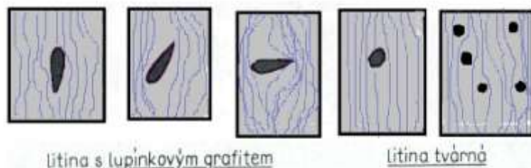
Obr. 64 Princip vzniku napětí při různém natočení lupínkového grafitu (nevzniká u tvárné litiny)
