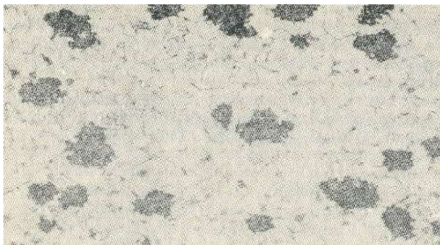
Obr.67 vybrus temperované litiny- vločkový grafit
